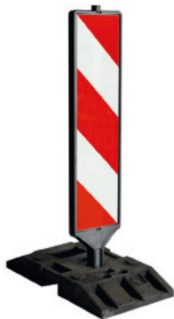
Le basi di appesantimento e ancoraggio per delineatori, sono realizzate al 100% con materiale plastico e gommoso di riciclo. Garantiscono alta resistenza ad oli, sale e ghiaccio. Nella parte superiore vi sono le aperture per l'inserimento di pali a sezione tonda o quadra da 40 o 60 mm. Trasportabili facilmente tramite le due maniglie laterali.
